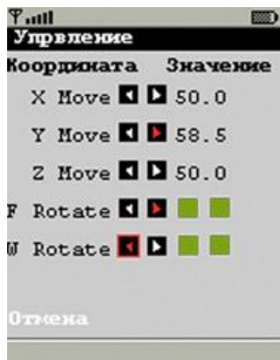
Рис. 5. Интерфейс пользователя клиентской программы для мобильного устройства
